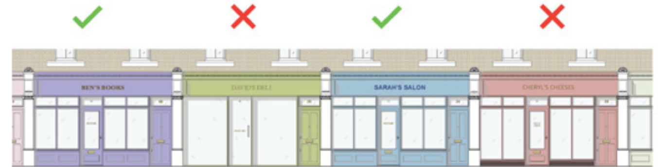
4.2 Restore stall risers
